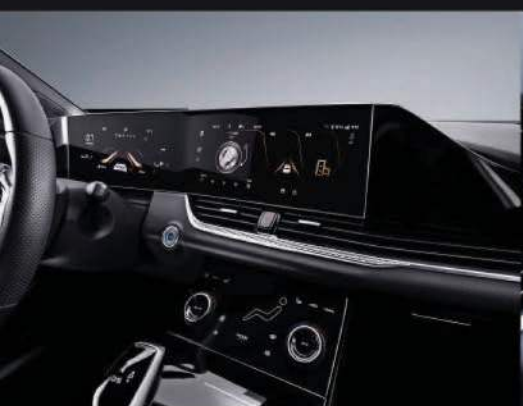
شاشة مزدوجة بمقاس 12.3 بوصة + شاشة 7 بوصة تعمل باللمس للتحكم بالتكييف Dual 12.3-inch Screen + 7-inch Air Conditioning Touch Panel
